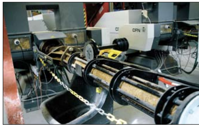
OPVARMNING: Varmepresseren er hjertet i fabrikkens produktionslinje. Her varmes halmen op til mellem 150 og 170 grader celsius og presses hårdt sammen. Derefter rives halmen op igen.
